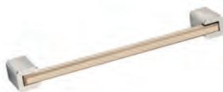
Maniglia 58FN finitura supporti nichel satinato inserto in tinta con anta faggio naturale anta L 15 → passo 64 mm anta da L 30 a L 60 → passo 160 mm anta L 90 → passo 320 mm
